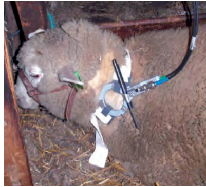
Ein Prototyp des implantierten Defibrillators, dessen Batterien sich von außen wieder aufladen lassen, wird im Langzeitversuch am Schaf getestet.
