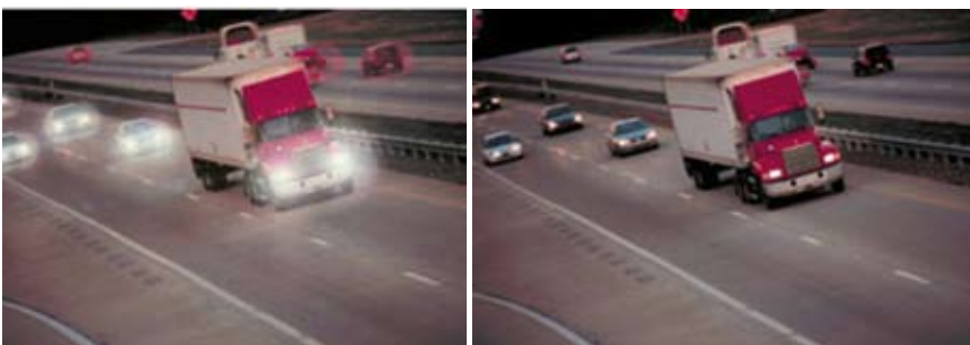
Straßenverkehrsszene. Links: ohne Korrektur von Aberrationsfehlern höherer Ordnung, rechts: mit Korrektur
